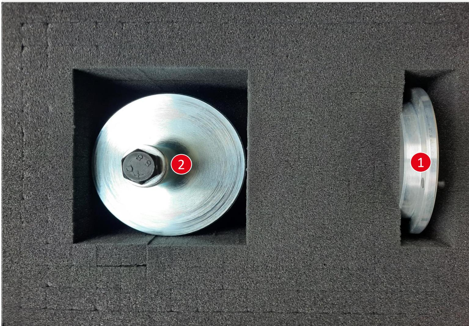
1 Einbauwerkzeug Wellendichtring
